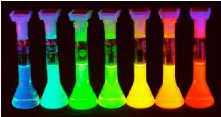
CdSe/Zns nanodots: Verschiebung der Absorption durch Variation der Partikelgröße
