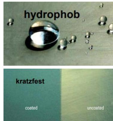
Beschichtungen zur Funktionalisierung von Oberflächen (EPG AG)
