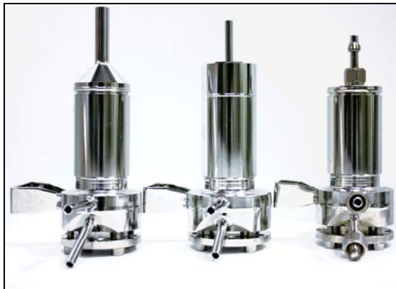
Abb.1: Pulsationsarme Verdampfer mit unterschiedlicher Spezifikation. Entwickelt am ICVT
